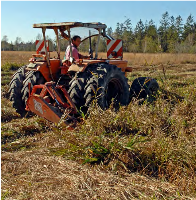
Streumahd mit Zwillingsreifen und Messerbalken – schont Boden und Tiere
